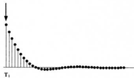
Рис. 2. Интерполированная характеристика КИХ фильтра после момента времени T_1
